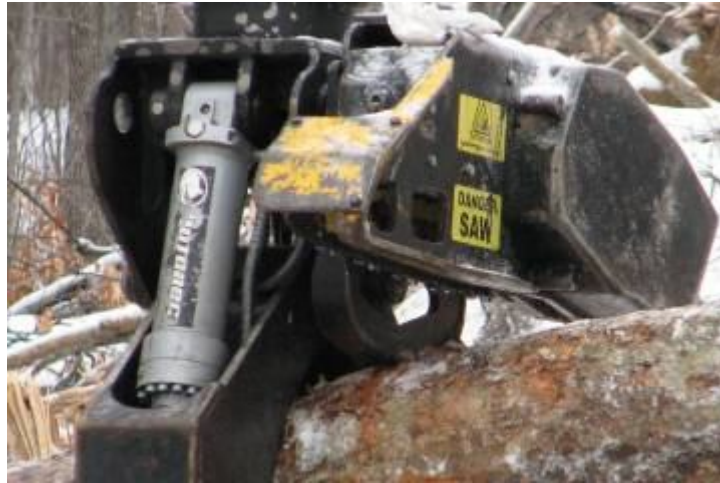
Figure 5. Boîtier de la scie de tronçonnage installée sur le grappin de la chargeuse.
