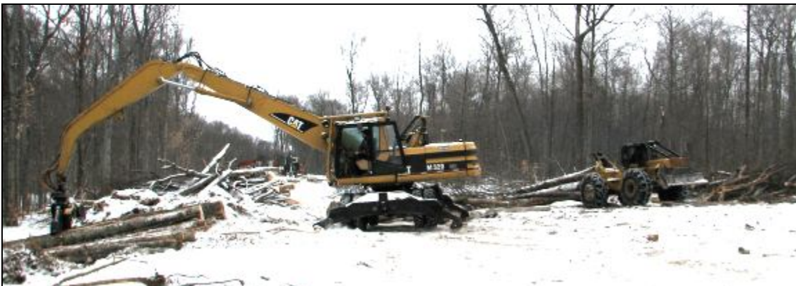
Figure 4. Débardeur à câble 640D arrivant à la jetée avec des tiges partiellement ébranchées. La chargeuse complète l'écimage, fait l'empilage des tiges et forme les amoncellements de résidus.
