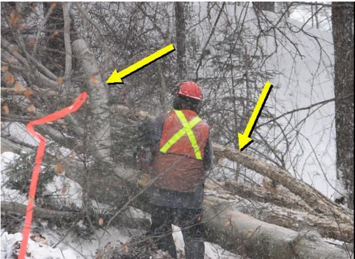
Figure 2. Ouvrier-écimeur au travail dans un groupe d'arbres abattus. Les flèches indiquent des portions de la cime qui sont habituellement coupée. Pour la production de bois de granule, ces branches demeureraient attachées à la tige.
